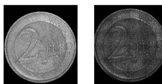
Figure 30 : Hologramme reconstruit par convolution
