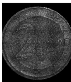
Figure 29 : Hologramme reconstruit par convolution
