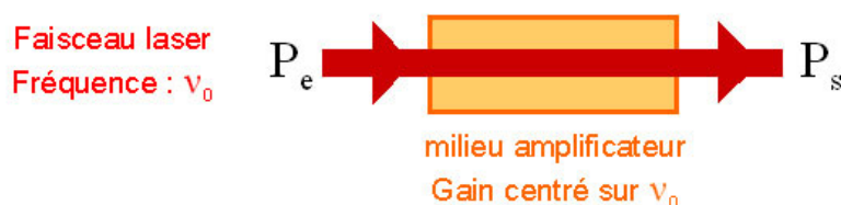
Figure 13 : Puissance en entrée et en sortie du milieu amplificateur.
