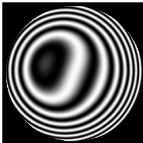
Figure 27 : Écart normal en présence d'aberration sphérique du 3ème ordre et d'un basculement de M1
