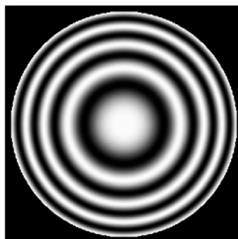
Figure 25 : Écart normal de défocalisation et interférogramme
