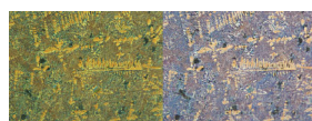
Figure 15 : Observation en contraste interférentiel différentiel d'un alliage d'aluminium et de silicium pour 2 positions différentes du prisme, de Nomarski les photographies (a) et (b) sont prises avec un objectif x10
